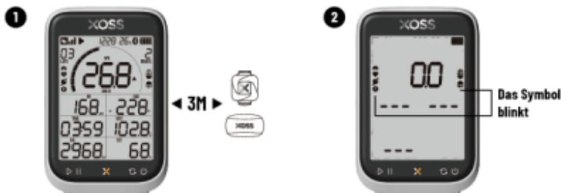
Stellen Sie das Gerät nicht weiter als 3 Meter vom Sensor entfernt auf und halten Sie es 10 Meter vom Sensor anderer entfernt.
