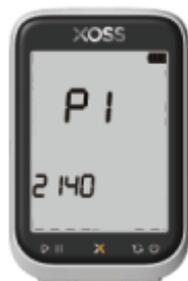
**CONFIGURACIÓN DE LA CIRCUNFERENCIA DEL NEUMÁTICO (mm)**
