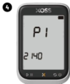
**Réglage de cirage du pneumatique (mm)**
